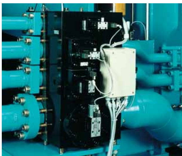
Логические блоки обеспечивают быстрые, но плавные рабочие циклы
