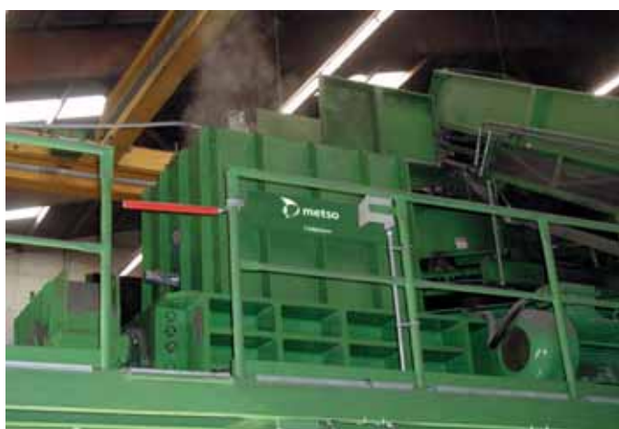
Роторные ножницы RO 16-6M с электроприводом: установка по переработке резиновых отходов
