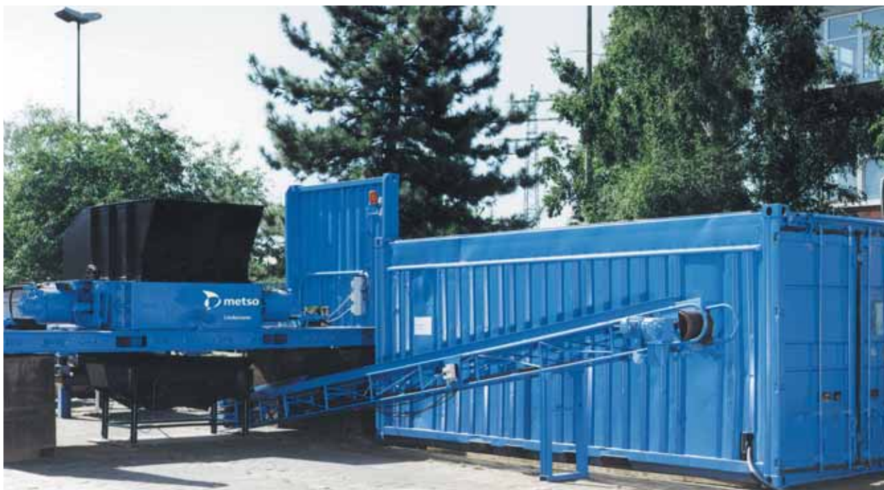
Два 20-футовых контейнера (согласно ISO) позволяют без проблем перевозить мобильные роторные ножницы моделей RO 10-5 до RO 22-8
