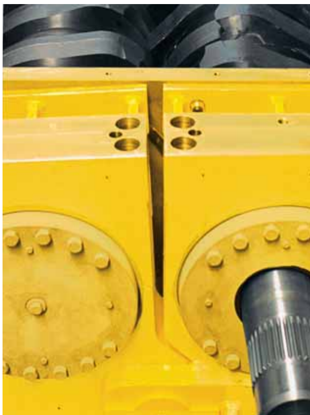
Саморасширяющийся корпус обеспечивает максимальную безопасность при переработке несортированных отходов
