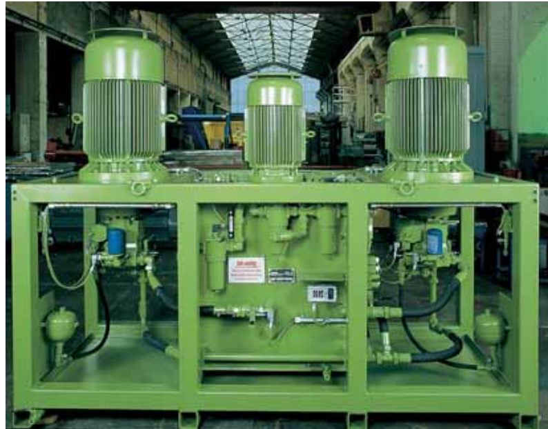
Замкнутая гидравлическая цепь требует минимального обслуживания и ухода
