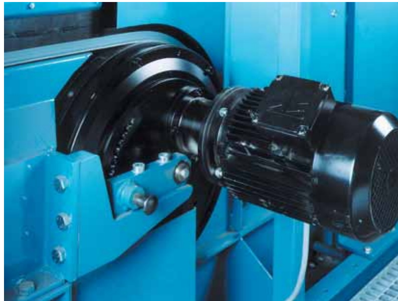
Магнитный ротор с прямым подключением к двигателю и регулируемым положением
