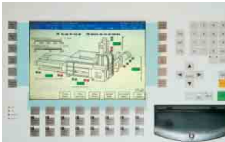
Многофункциональный терминал: визуализация данных процесса и онлайн-поддержка оператора
