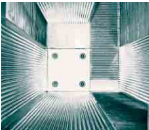
Футеровка пресс-плит со специально разработанным профилем поверхности обеспечивает машине высочайшую эксплуатационную надежность
