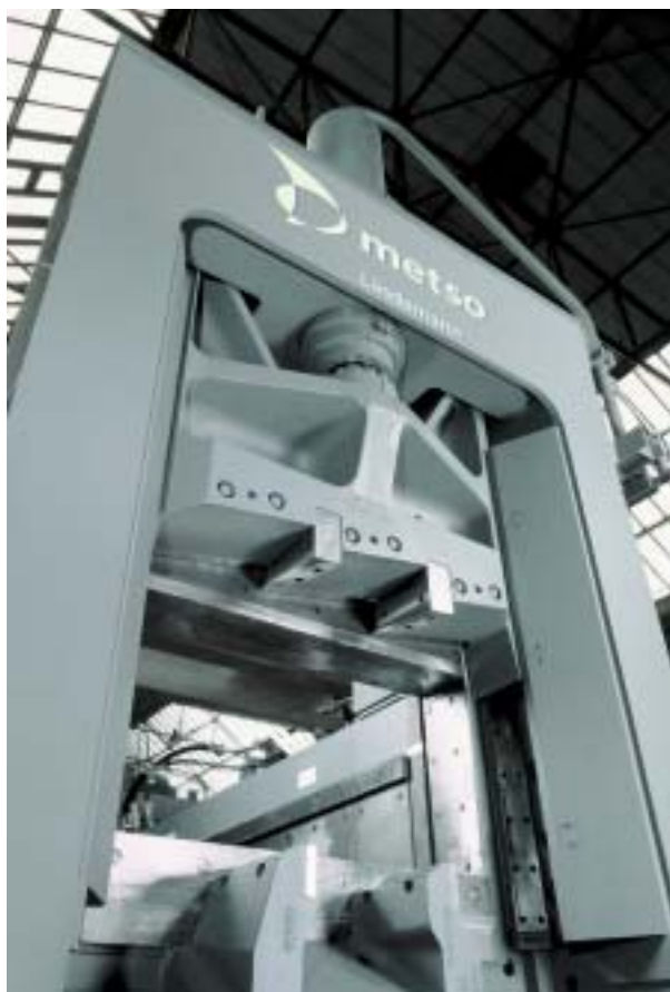
Специальная комбинация поперечных и продольных ножей Lindemann
