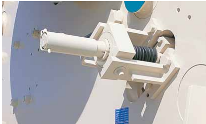
Регулировка дробилки серии С всегда безопасна, т. к. не предполагает установки или снятия регулировочных прокладок.
