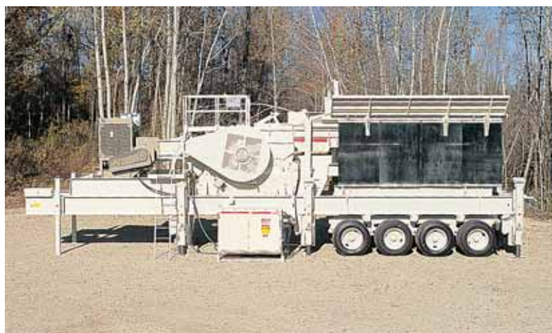
Модель S3055 (загрузочное отверстие 1400 x 760 мм), установленная на передвижной, полностью мобильной дробильной установке.
