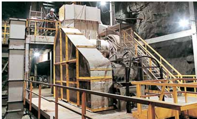
Крепежная система щековых дробилок серии С со штырями и болтами допускает легкую транспортировку и перемещение даже при подземных работах.
