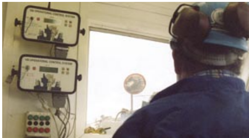
Система операционного управления дробилкой VSI (VOCS).
