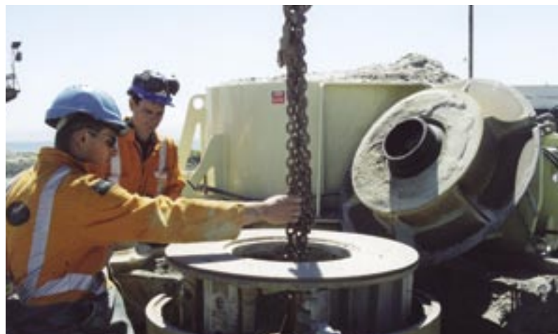
Ротор дробилки Varma заменяется быстро и без усилий.
