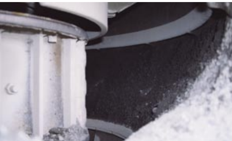
Дробильная камера машины Varmac. Видна хорошо сформированная минеральная постель.
