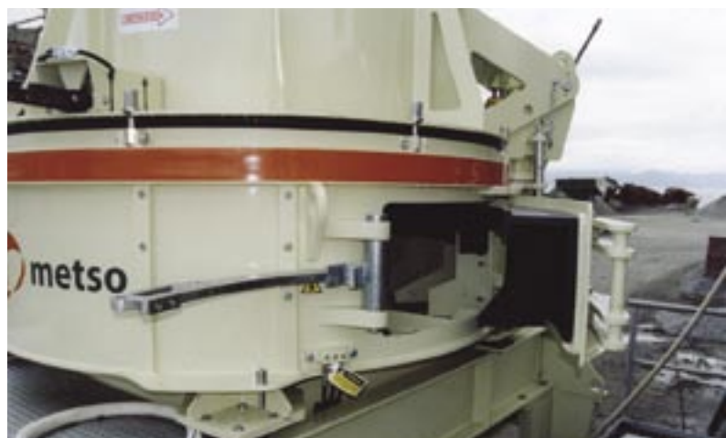
Смотровой люк обеспечивает простой доступ в дробильную камеру.
