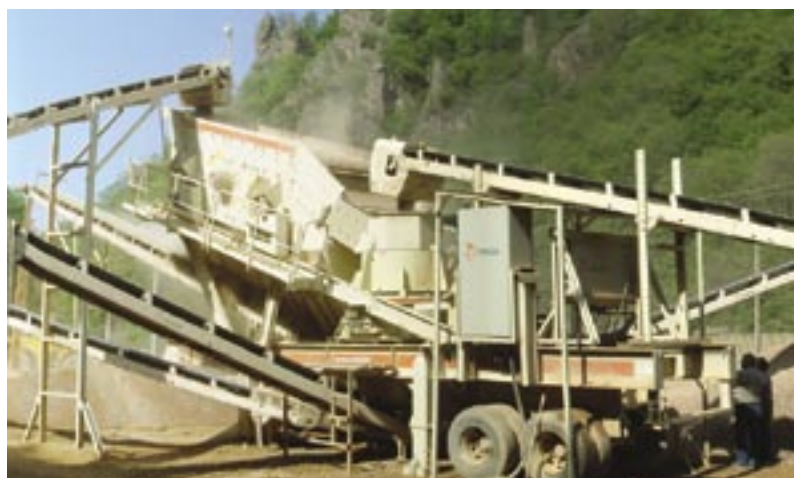
Дробилка Varмас легко монтируется на передвижной установке.
