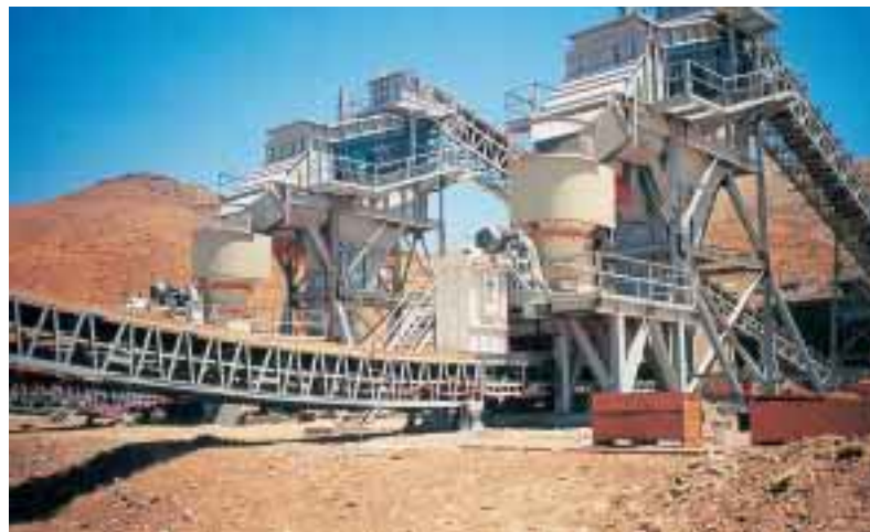
Установка с двумя дробилками Nordberg GP500S – США.
