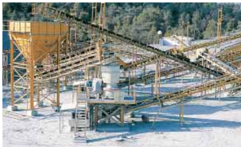
Конусная дробилка Nordberg GP11 в стационарном исполнении на Кипре.
