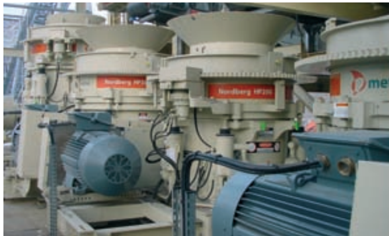
Фабрика: одна дробилка HP500, одна дробилка HP300 и две HP200 на дроблении амфиболита.
