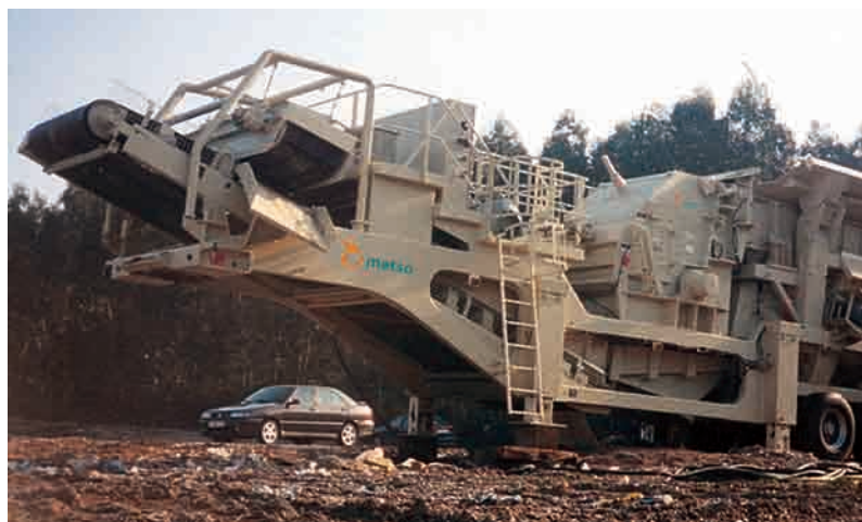
Подрядные работы: дробилка NP1315, установленная на шасси Nordberg NW.
