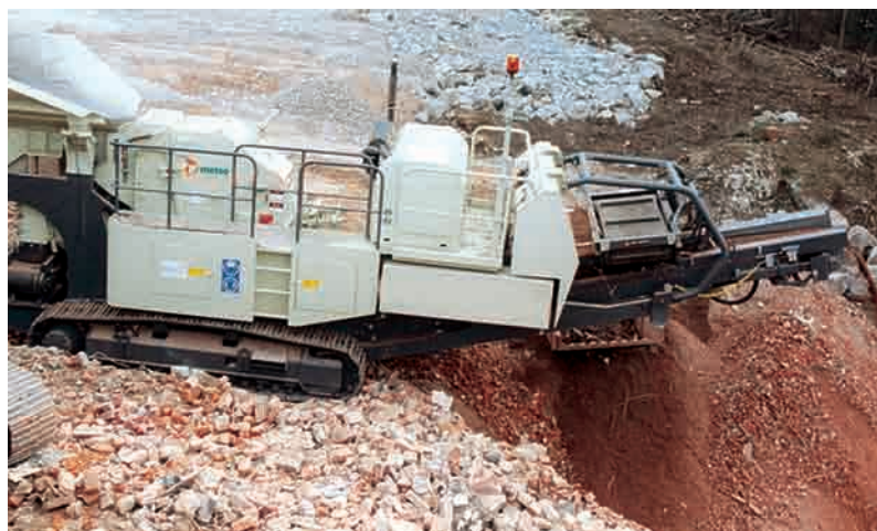
Переработка отходов: дробилка NP1007 на мобильной установке Lokotrack.
